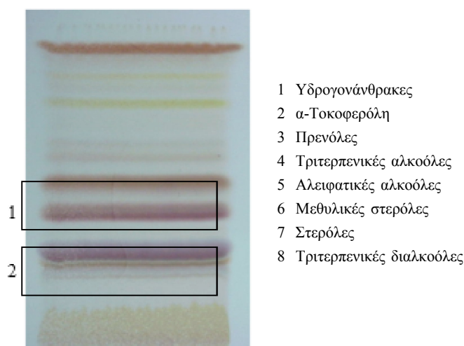
Σχήμα 1 — Χρωματογραφία λεπτής στιβάδας του κλάσματος ασαπωνοποιήτων υλών από πυρηνέλαιο που εκλούεται δύο φορές με εξάνιο:διαιθυλαιθέρα (65:35), που αναπτύσσεται με SO 4 H 2 (50 %) και θερμαίνεται. Οι ζώνες που θα πρέπει να αποξεστούν είναι αυτές που περιλαμβάνονται στο παραλληλόγραμμα: 1 είναι οι ζώνες για τις αλειφατικές αλκοόλες και 2 οι ζώνες για τις στερόλες και τριτερπενικές διαλκοόλες.
